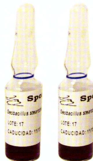
Sporigam<sup>®</sup> en ampolletas es un indicador biológico autocontenido diseñado para validar procesos de esterilización con vapor a 121°C. Cada unidad está conformada por una ampolleta de vidrio que contiene medio de cultivo, una población definida de esporas *Geobacillus stearothermophilus* e indicador de pH.
